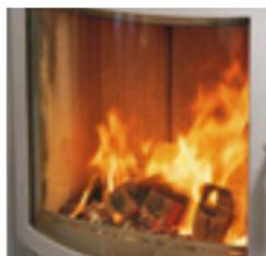
**2** Hat sich ein Grundglut gebildet, legen Sie 3 bis 4 Briketts in fingerbreitem Abstand auf die Glut. Um ein schnelles Überzünden der Briketts zu erreichen, sollte der Luftschieber für eine kurze Zeit ganz geöffnet werden. Sobald die Briketts voll entzündet sind, reduzieren Sie die Luftzufuhr auf Normalbetrieb.
